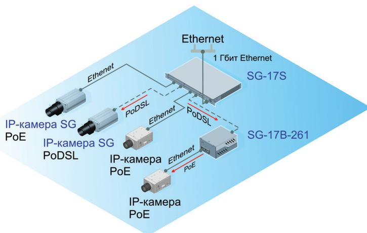
Камеры подключаются к модульным интерфейсам коммутатора ( SG-17S, SG-18S). В шасси SG-17S может быть установлено до 4-х различных модулей.
