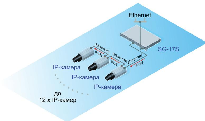
Все IP-камеры Sigrand с Ethernet интерфейсом имеют встроенный двух портовый коммутатор, что позволяет организовать их подключение «цепочкой» в режиме транзитного питания от одного порта PoE.
