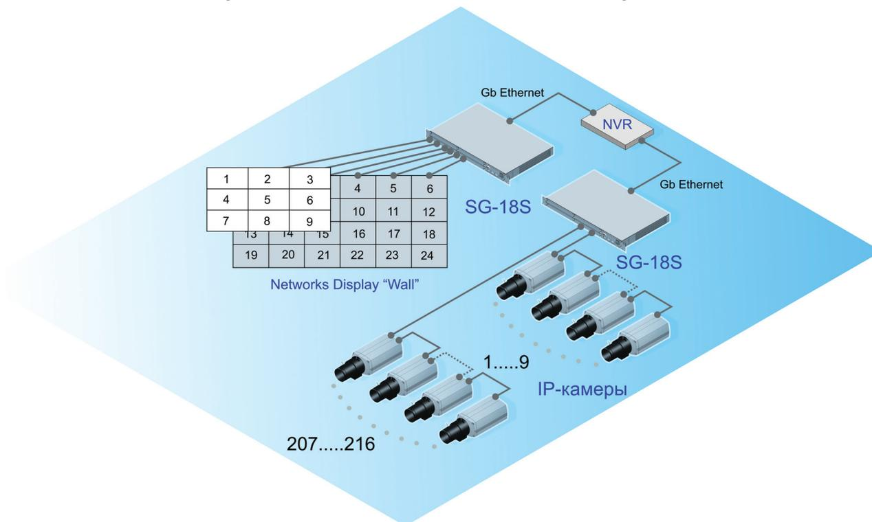
Для наблюдения за большим массивом IP-камер (диспетчерские, пункты управления и т.д.) используются сетевые дисплеи SG-1D. «Видеостена» составлена из 24 дисплеев SG-1D, настроенных на отображение девяти IP-камер.
