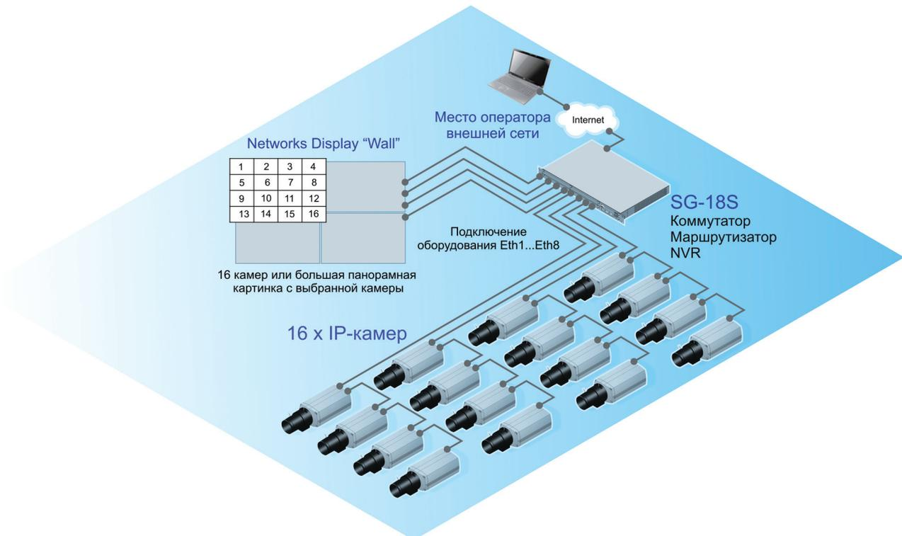
Для наблюдения за небольшим массивом IP-камер с целью минимизацией затрат на коммутаторе SG-18 можно реализовать функцию NVR.
