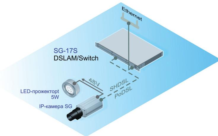
Встраиваемый в IP-камеру Sigrand SHDSL модуль позволяет передавать видеоизображение между камерой и SHDSL интерфейсами на дальние расстояния.
