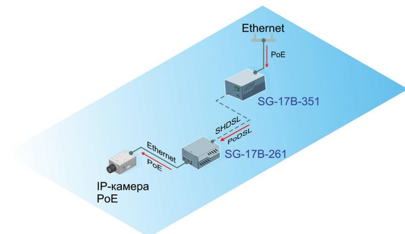
Комплект из двух модемов выполняет функцию удлинителя PoE через SHDSL соединение.
