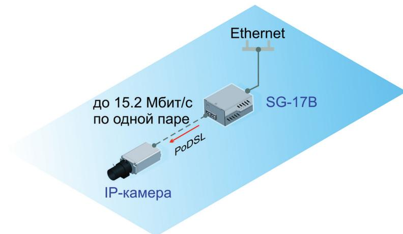
IP-камера Sigrand со встроенным SHDSL интерфейсом подключается к модему SG-17B или DSLAM SG-17S. Скорость в линии достигает 15296 кбит/с по одной паре.
