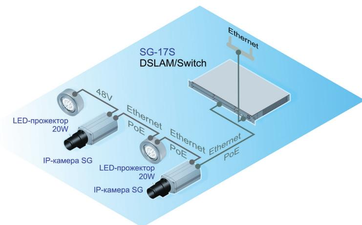
IP-камеры Sigrand и LED прожекторы Sigrand имеют встроенный Ethernet-коммутатор на два порта, что позволяет в целях оптимизации прокладки кабеля организовать их подключение «цепочкой» в режиме транзитного питания от одного порта Ethernet.
